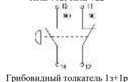
Рисунок 9. Принципиальная электрическая схема поста управления кнопочного
